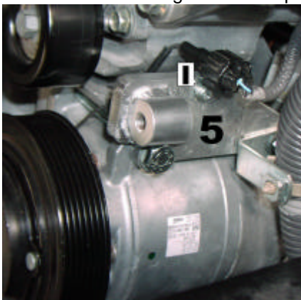
Montare la staffa 5 con viti TE10-1,25x110 , rimontare connettore I Assemble the bracket 5 with screws TE 10-1,25x110 then reassemble the connector I
